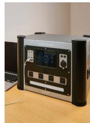
UPS (無停電電源装置)
